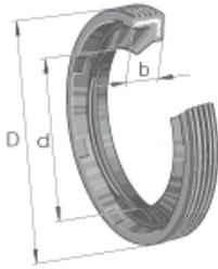
**Bague d'étanchéité pour roulement à aiguilles G14X21X3-B**
