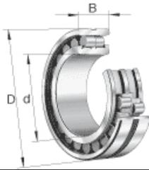
**NN 3011-AS-K-M-SP - Zylinderrollenlager zweireihig, Messingkäfig**
