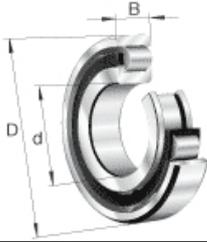
**N 305-E-TVP2 - Zylinderrollenlager einreihig, Polyamidkäfig**
